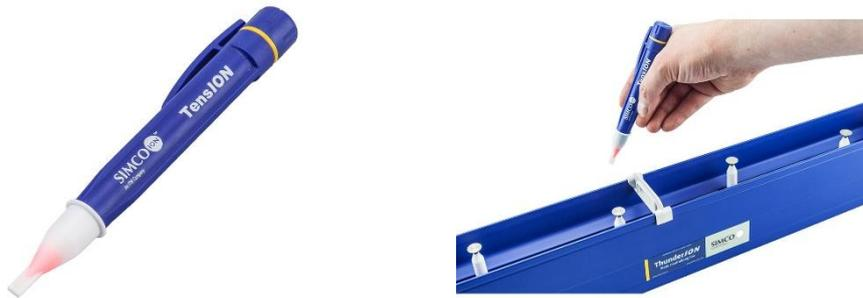
TensION 电压测试笔适用 AC & DC 静电消除器及静电产生设备的检测使用，非接触感应亮灯显示模式，操作非常安全和便捷，操作时无需接触到静电设备的发射极(离子针)，只要依据不同设备的工作电压测量距离就能通过测试笔尖端(白色区域)显示灯(红色亮灯与否) 判别静电设备高压输出是否正常。高压是设备运行所需的最低电压，为了获得设备运行的指示，必须检查所有点。TensION 测量笔是一款体积细小、轻巧，且携带、操作十分简单和安全的测量器，是静电控制设备使用者的必备测量工具。
